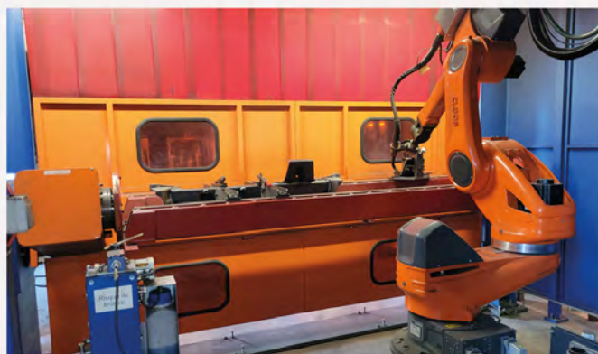
SOUDURE ROBOTISÉE CAPACITÉ 3000 X 1200 MM
